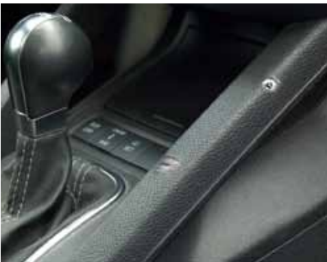
Verformung in der Kunststoffverkleidung
