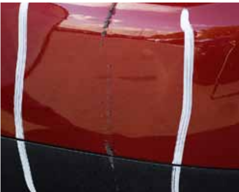
Deformation der Stoßfängerverkleidung
