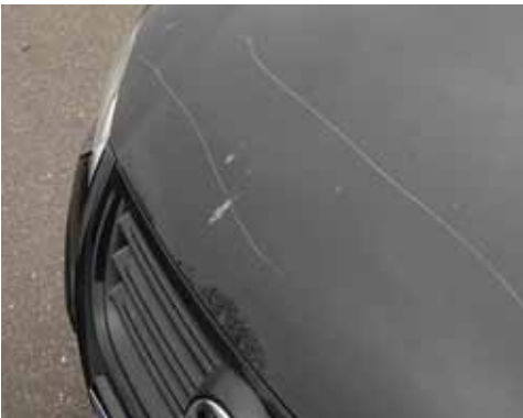
Beschädigung des Basislackes
