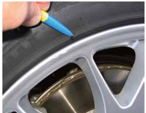
Scheuerleiste leicht eingeschnitten
