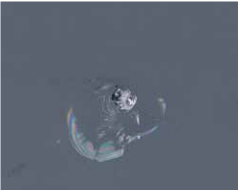
Steinschlag mit Rissbildung
