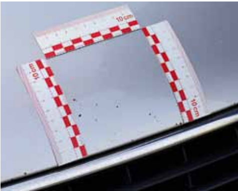
Mehr als fünf Steinschläge pro 10 cm 2
