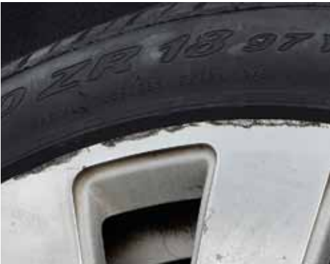
Beschädigung Felgenhorn mit Materialabtragung
