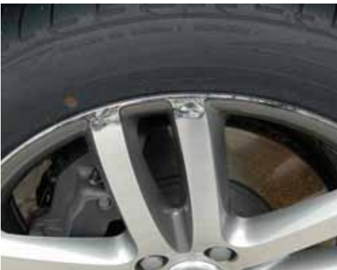
Materialabtragung an der Felge
